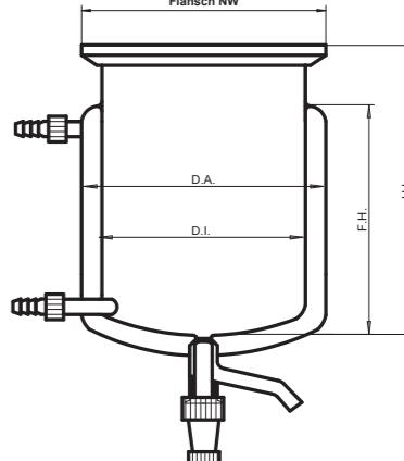
**Temperierbare Reaktionsgefäße mit Heizmantelanschluss DN15-Flansch und 10 mm "J" Ventil**
