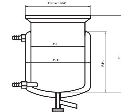
**Temperierbare Reaktionsgefäß mit Heizmantelanschluss GL18-Olive und Ablauf S40-Schliff**
