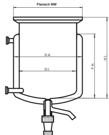
**Temperierbare Reaktionsgefäße mit Heizmantelanschluss GL18-Olive und "L" Ventil**
