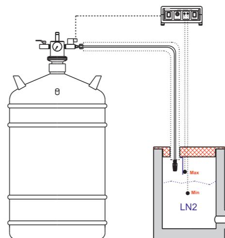
Automatische LN2-Niveauregulierung mit einem korrespondierenden Dewargefäß
