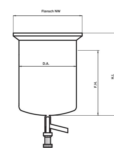
**Temperierbare Reaktionsgefäße mit Heizmantelanschluß GL18-Olive**
