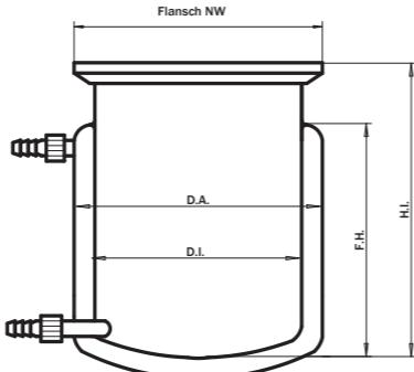
**Temperierbare Reaktionsgefäße mit Heizmantelanschluß DN15-Flansch**
