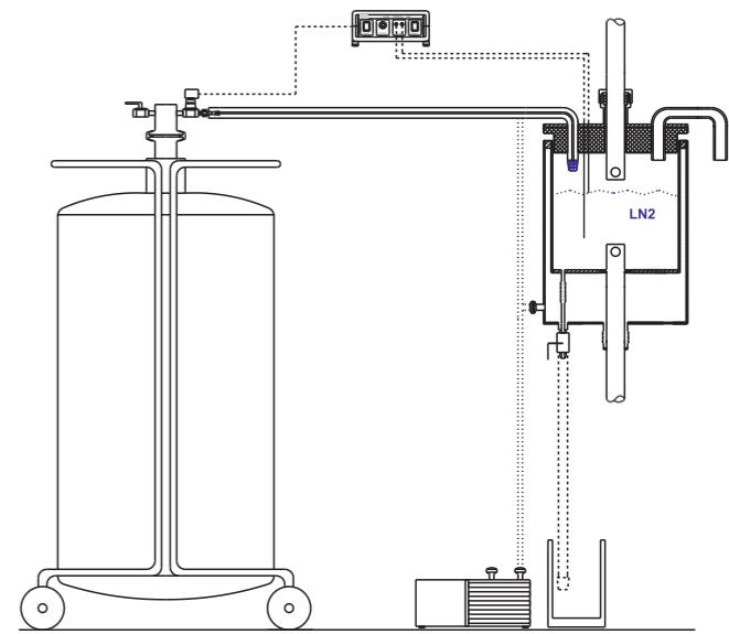
Automatische LN2-Niveauregulierung an einem Dewargefäß für Zugversuche
