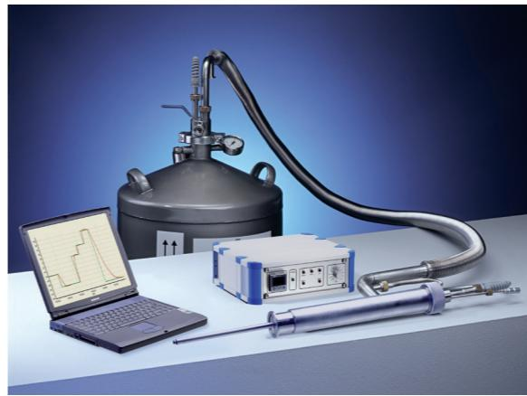
KALTGAS-System Typ TG-LKF für einen Temperaturbereich von  $+100^{\circ}\text{C}$  bis  $-180^{\circ}\text{C}$ , mit einer Temperaturstabilität bis  $\pm 0,2^{\circ}\text{C}$ .
