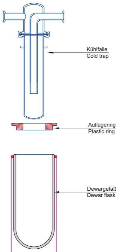
**Kühlfalle aus V2A Typ KF 54 V mit Dewargefäß**
