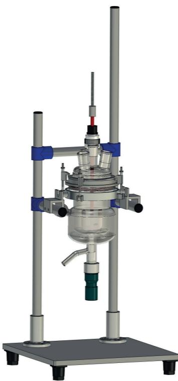
Tischgestell NE (Rohrdurchmesser 27mm)
