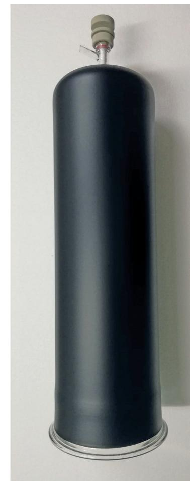
Reaktor und Deckel mit UV undurchlässiger Sicherheitsbeschichtung
