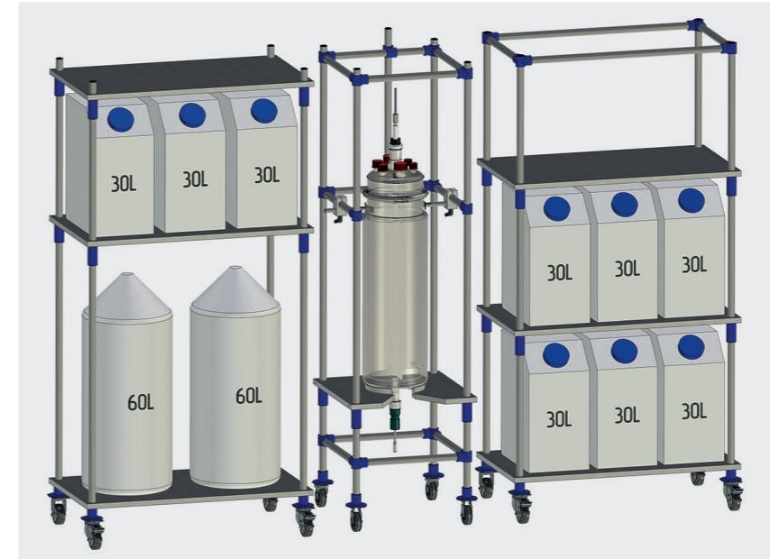
Fahrbarer Reaktor mit mobilen Dosiergestellen /
