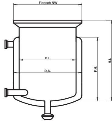
**Bauchige Reaktoren mit Heizmantelanschluss DN15 Flansch**
